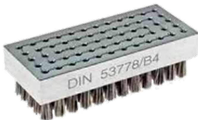
Brosse utilisée pour l'ancienne norme DIN
